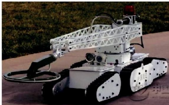
图 2 三节履带式机器人
