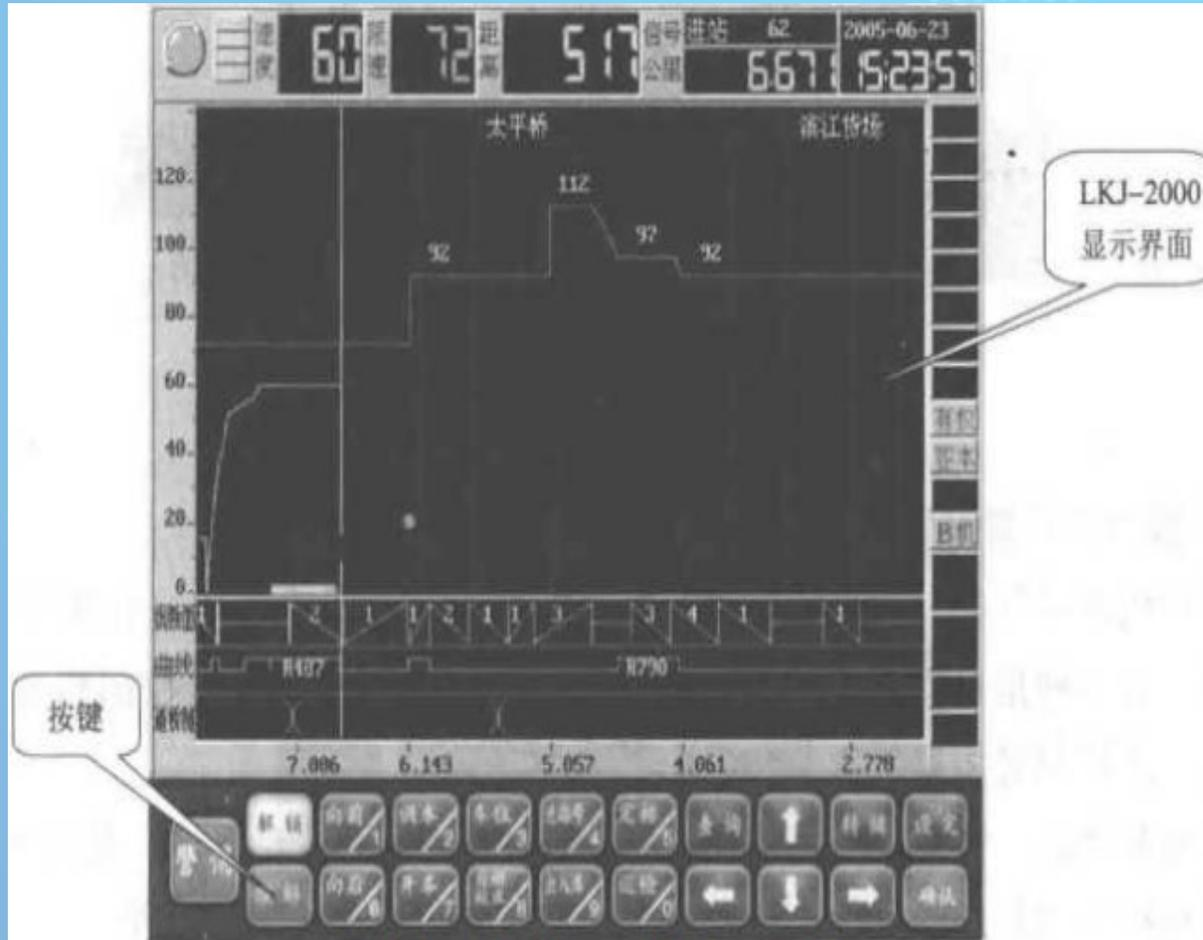
LKJ2000 型监控记录装置是在 LKJ-93 型监控的基础上发展起来的新一代防止“两冒一超”的机车车载安全硬件设备，主机采用了双机热备，自动转换，提高了质量保证，并使用了大屏幕彩色液晶显示屏，可以实时显示机车当前位置、前方限速、信号机、车站和线路等情况，较为直观、全面地提供了列车运行所需要的各种安全信息，其显示器界面如（图一）所示，该装置对安全行车起到了重要的指导作用和控制作用。
