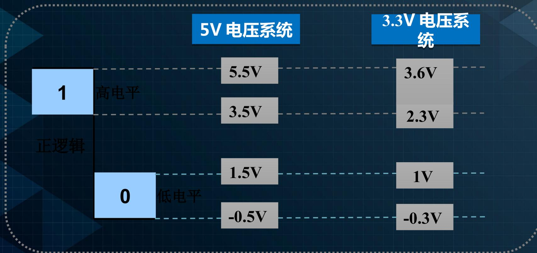
数字信号是一组由 0 和 1 表示的二进制数值，在数字电路中，通常用低电平表示 0，用高电平表示 1。
