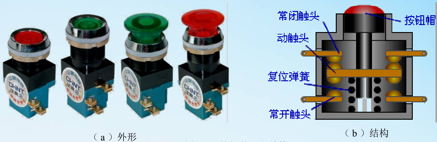
图 2-7 按钮外形和结构
